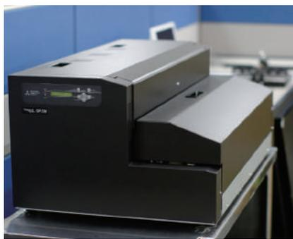
北川課長は、描画を縦横方向に太らせたり細くしたりできる「ボールド機能」にも着目する。「バーコードでは、印刷で太ったり細くなったりすると、読み取り精度に影響する。『TDP-750』のボールド機能は、縦・横の両方向で補正ができる。データの再現性を高めるために、ネガの段階でしっかりと補正しておきたい」バーコードは、シビアなものだと数十ミクロンオーダーの精度が求められるという。また、同社の版を使う印刷会社の特性に合わせた出力にも、一層柔軟に対応できる可能性も出てきた。「今後、さらにどのくらいの調整が可能なのか検証していきたい」と考えた。
