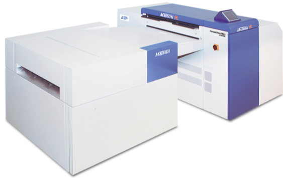
長時間連続運転を可能とするシングルオートローダー(SAL)
